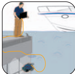
Inspección anclajes y amarres, verificar profundidad de dragado y mantenimiento en piscifactorías
