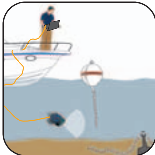
Inspección de boyas y cadenas, anclas encalladas y problemas en compuertas
