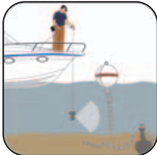
Inspección de boyas, cadenas, anclas encalladas y problemas en compuertas
